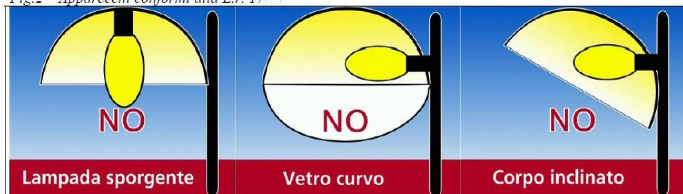
Fig.3 – Apparecchi che per configurazione non sono conformi alla L.r. 17
