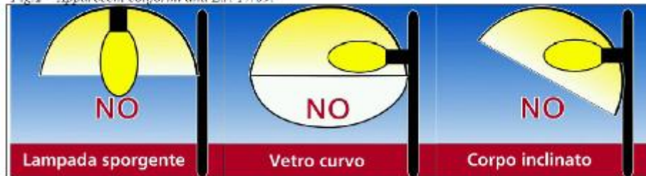
Fig. 3 – Apparecchi che per configurazione non sono conformi alla L.r. 17/09.
