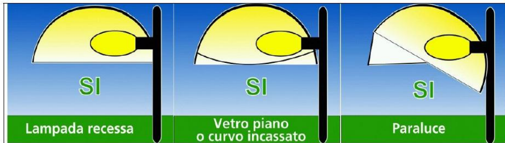
Fig.2 – Apparecchi conformi alla L.r. 17
