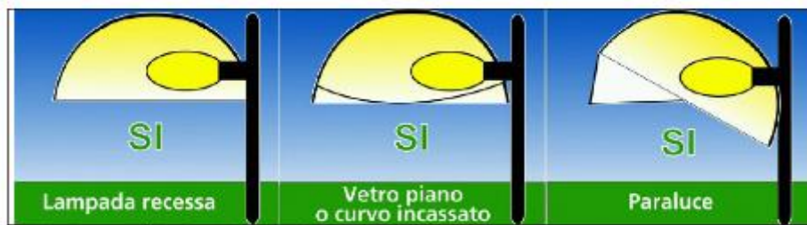
Fig. 2 – Apparecchi conformi alla L.r. 17/09.
